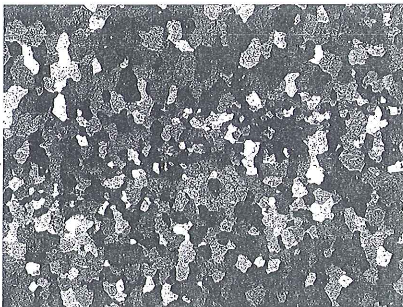
Bild (fig.) 3 : Mikrogefüge des Schweißgutes (microstructure of weld metal) Ätzmittel (etching solution) : HBF4 elektrolytisch (polar. Licht)
